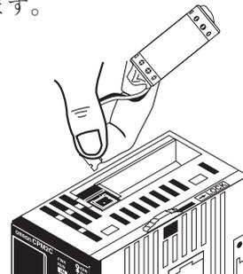
4. 新しいバッテリーを取り付けます。コネクタの方向を合わせて差し込み、コードがはみ出さないようにバッテリーを収めます。
