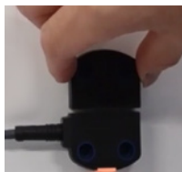
②アクチュエータを近づけると、赤LEDが点灯しティーチング開始。10秒後に黄色高速点滅開始。その後、電源OFF*2
