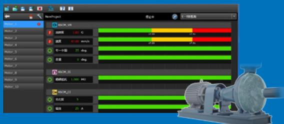
複数のモータの状態を正常時(緑)、注意時(黄)、異常時(赤)で表示。時系列でモータ状態の移り変わりが確認できます。
