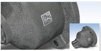
トランスミッション(鑄造部品) への2次元コード印字
