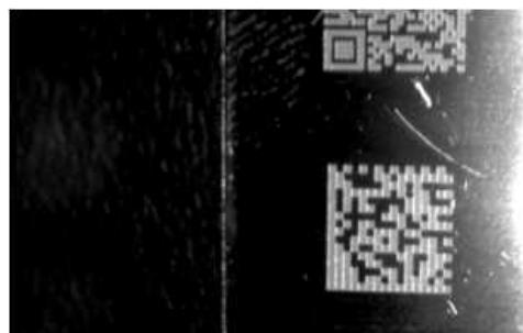
**照明の変更による高コントラスト化**
