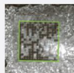
スクラッチによる一部破損
