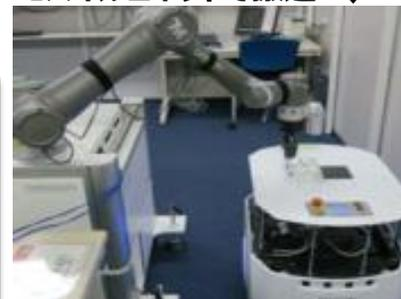
モバイルロボットに協調ロボットをのせて → (開発中)
