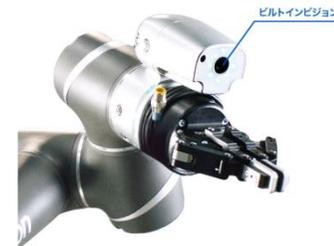
また、協調ロボット TMシリーズには、アームの先端にビジョンセンサが標準で搭載（ビルトインビジョン）されており、移設や再配置をしても、キャリブレーションする必要がなく【TMランドマーク】を読み取るだけでロボットアームとワーク間の相対的な関係が変更され、すべてのポイントが再生成されます。その結果、取替えや移設、追加投入時の設定時間の短縮が可能になります。
