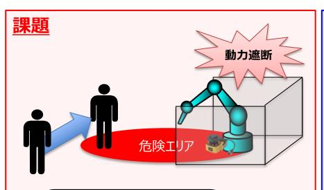
危険エリアに人が侵入したとき、ロボットの動力遮断することなく安全を確保したい・・・
