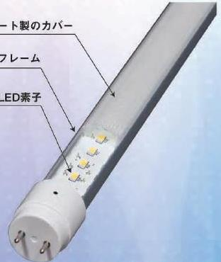
飛散防止試験(JEL218)適合: 200gの鋼球をぶつける、3mから落とすなどの試験を行い、割れないこと・破片が範囲外(半径2.2m)に飛散しないことを確認しています。
