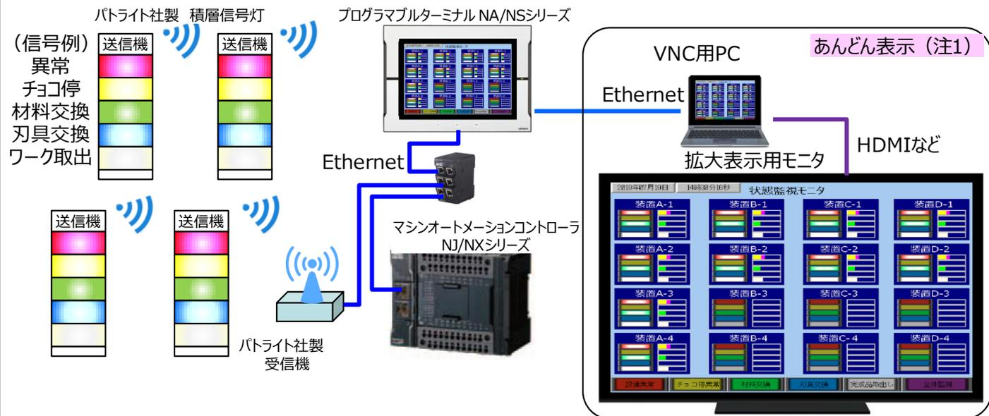
パトライト社製 ワイヤレス・データ通信システムを使って積層信号灯からの情報を取り込んだ例です。積層信号灯やワイヤレス・データ通信システムの詳細は、パトライト社までお問い合わせください。
